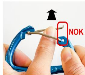
Nietung nicht ok, von außen sichtbares Teil ist flach
